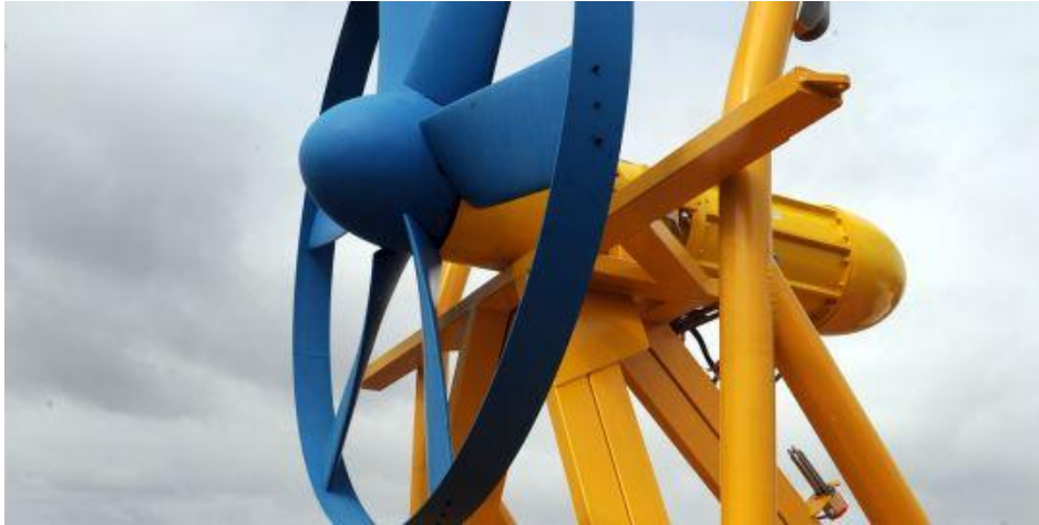
Un prototype d'hydrolienne. AFP/FRED TANNEAU
