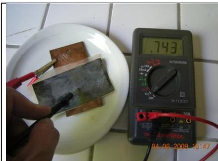
on obtient une tension de l'ordre du volt avec une jonction de papier imbibé d'eau salée entre la plaque de cuivre et de zinc.
