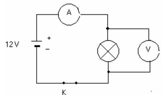
2°/ Pour chaque lampe mise à votre disposition, relever la valeur de la tension  $U$  aux bornes de la lampe ainsi que celle de l'intensité  $I$  du courant électrique qui la traverse en complétant simultanément le tableau ci-dessous.
