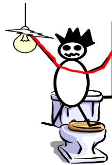
Contact par l'intermédiaire d'une douille mal isolée.
